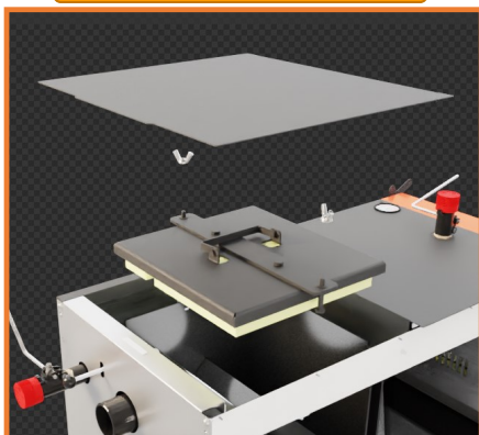
Vyjmutí čistících dvířek
