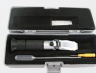
**Ruční refraktometr 402 ATC** k měření mrazuvzdornosti nemrznoucích kapalin.
