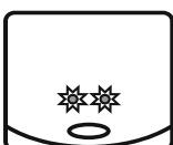
Ohřívač nehřeje, zapnutá aktivní ochrana přehřátí spirály, napětí nižší než 218V.
