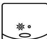
Ohřívač je zapnuty, ohřev je snížen, napětí nižší než 218 V.
