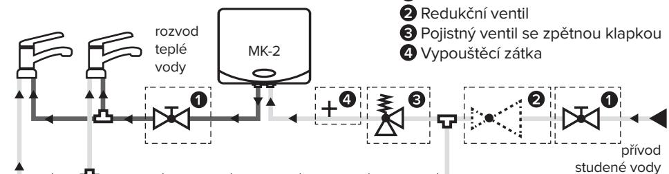
obr. 2: schéma zapojení ohřívače na plný tlak vody do vodovodního systému
