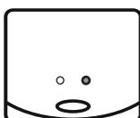
Ohřívač je zapnuty, ohřev je velmi snížen, napětí nižší než 202 V.
