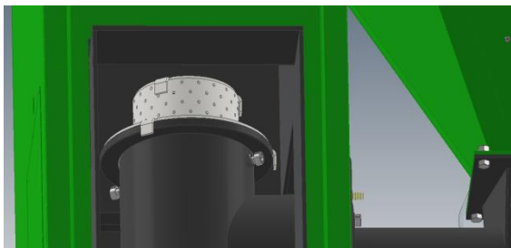
Obrázek číslo 11 Montáž příložky na hořák
